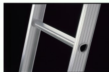
フレームと踏ざんの結合は ねじれに強いパルジ加工。
